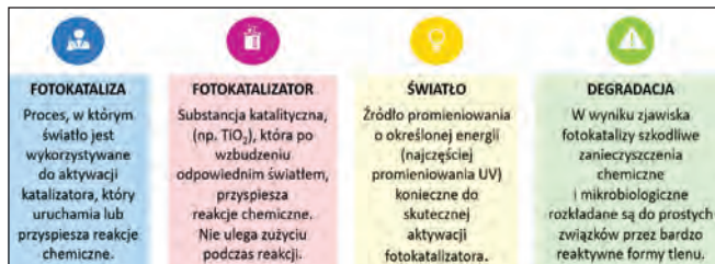
Rys. 1. Czynniki determinujące skuteczność procesu fotokatalizy
