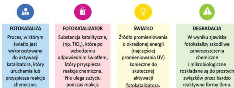
Rys. 2. Czynniki determinujące skuteczność procesu fotokatalizy
